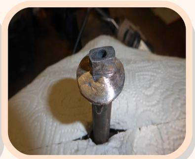
Je réalise deux méplats sur le coté opposé au filetage pour glisser une clef de 8 afin de serrer l'axe sur le tandem. Je pose une rondelle au niveau du collet que je vais braser. Elle servira d'épaulement coté gauche.
