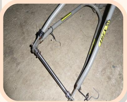
J'installe les deux supports permettant de crocher la remorque.
